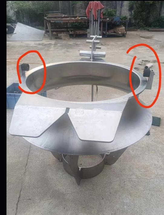
点位1在运行将近1年的时间时，5台泵有2台已经挂钩断裂，脱落。剩下有不同程度变形，后续厂家给的整改方案是增加挡流板，且增加两侧的支撑点来缓解不利影响。
