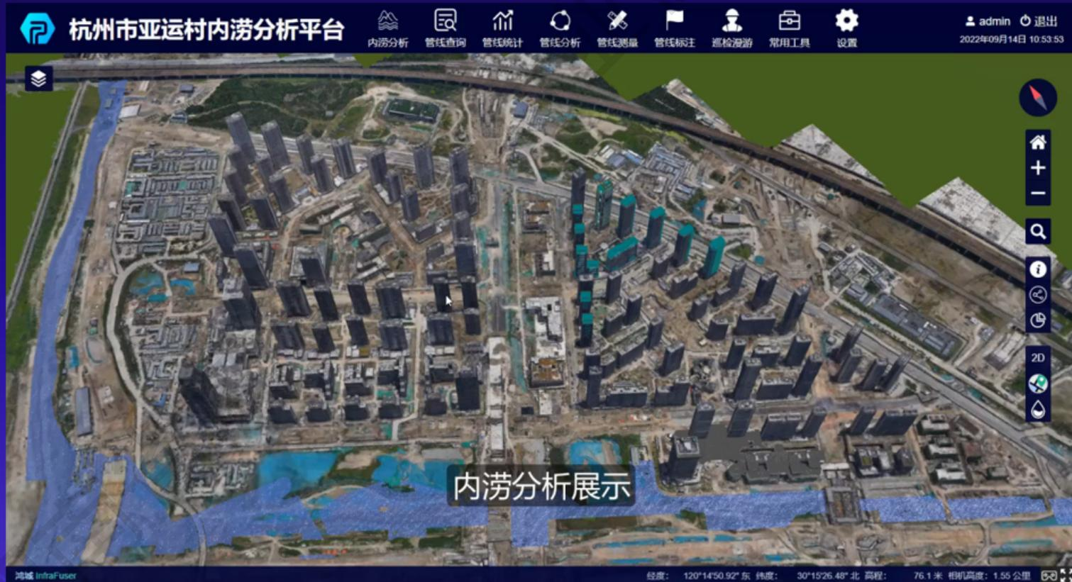
展示不同工况下积水区域，标注积水面积和该区域内最大积水点深度，动态模拟洪涝淹没过程
